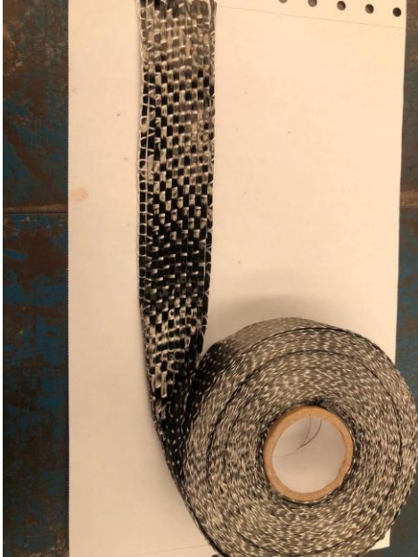
fita de carbono – 25 mm de espessura
