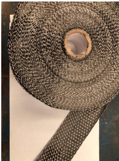
fita de carbono – 50 mm de espessura
